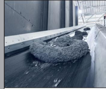
WAS GRÖßER IST – DIE BAUSCHIGEN SPÄNE – GEHT NACH RECHTS DIREKT INS STAHLWERK UND WIRD DORT WIEDER EINGESCHMOLZEN.
