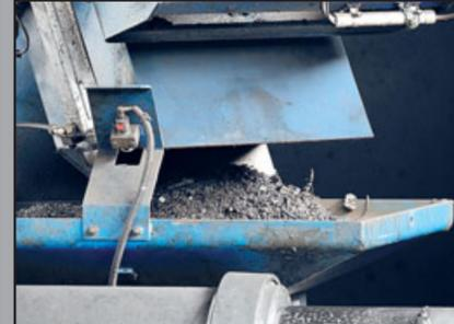
JETZT WIRD AUFGEMISCHT. HIER WERDEN DIE SPÄNE MIT SCHLEIFSCHLAMM ANGEREICHERT.
