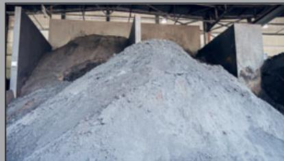
SO SIEHT SCHLEIFSCHLAMM AUS – IN EINER NORMALEN SCHMELZANLAGE WÜRD DER SCHLAMM GLATT VERPUFFEN.
